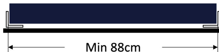
Abbildung 8: Der Abstand zwischen den Matratzenzentrierhilfen des Pflegebettes muss mindestens 88 cm betragen.
